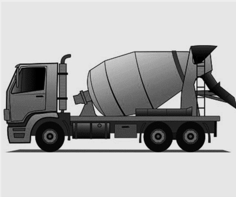
De grandes quantités de béton peuvent être livrées directement sur chantier par des camions mixers. Pour de petites quantités, le béton peut être fabriqué « à la main », en malaxant manuellement ou à l'aide d'un matériel de malaxage. Pour 1 m<sup>3</sup> de béton on utilise 350 kg de ciment, 680 kg de sable, 1 180 kg de gravillons
