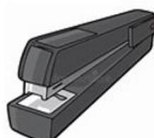
Agrafeuse avec agrafes de 14 à 16 mm ou vis de 13 à 15 mm (pour fixer les supports dans le film si le panneau est coupé et fixé au plafond).
