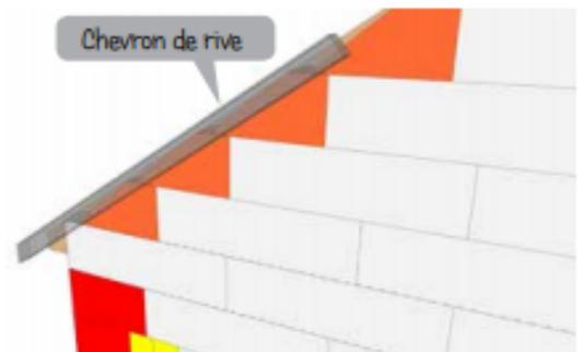
Finition et masquage du défaut d'alignement des blocs par la pose d'un chevron de rive.
