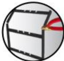
**!** Pour assurer l'isolation du mur en partie haute, il est nécessaire d'insérer un bloc extérieur (larg.:15 cm) coupé en deux sur la hauteur (Ht 15 cm). Les deux moitiés sont utilisables.
