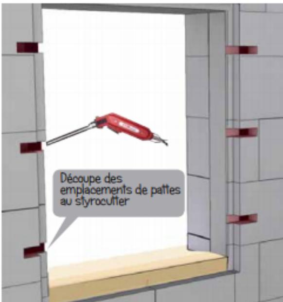
Il faudra utiliser des pattes de fixation permettant de compenser l'épaisseur de polystyrène en tableau.
