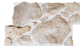
Pierre naturelle sur treillis ou Mix 50% pierre naturelle-50% pierre Néominéral sur treillis Epaisseur moyenne entre 1 et 4 cm Poids moyen : 54 kg/m 2 L. 58 x l. 33
